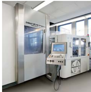
Deckel Maho DMU 50eVo linear, 5-Seiten-Bearbeitungszentrum mit 3D-Bahnsteuerung und Palettenwechsler
