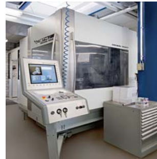
Deckel Maho DMU 60 P hi-dyn, 5-Seiten-Bearbeitungszentrum mit Schwenkkopf
